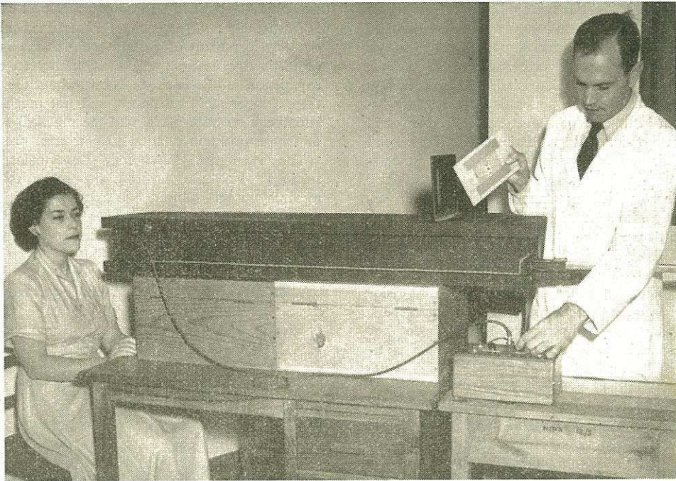
Apparaat wat gebruik word vir die blootstelling van voorwerpe onder wisselende toestande van beligting in 'n eksperimentele studie van die sigbaarheid van padtekens.
