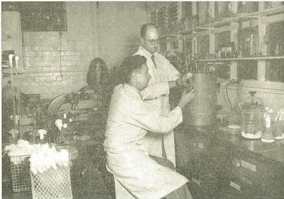
Die tap van 'n model-gistingsketel vir die brou van Kafferbier in die Nasionale Chemiese Laboratorium.
