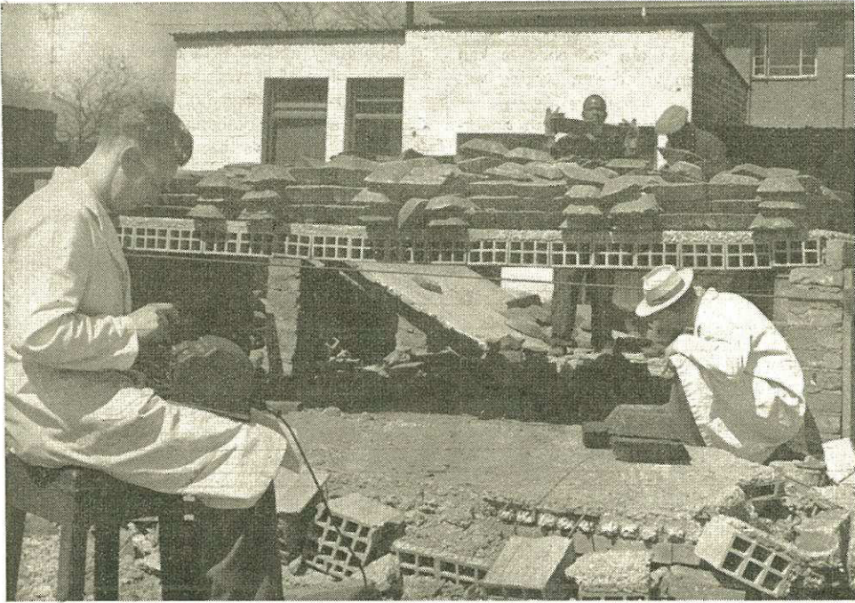
Hierdie vloere van voorafgespanne kleiteëls word tot breekpunt getoets tydens navorsing wat onderneem word deur die Afdeling Strukturele Ingenieurswese van die Nasionale Bounavorsingsinstituut.
