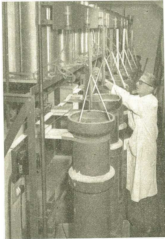
Kleinskaalse biologiese filtreerders vir die verwydering van melkeryuitvloeiels.
