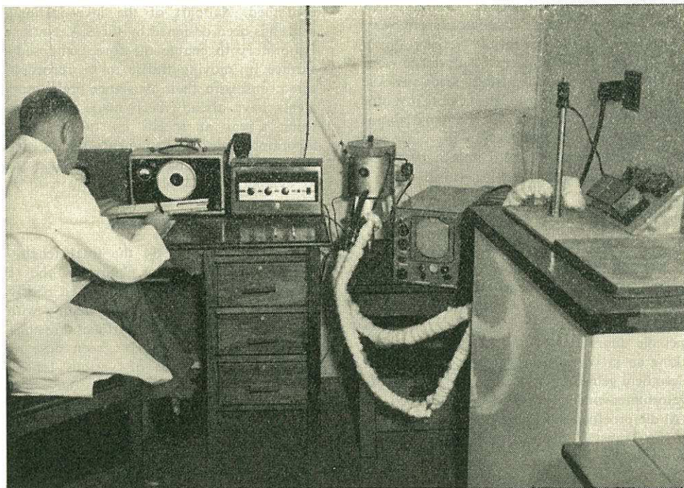
Apparaat vir die meting van die visko-elasticiteitsenskappe van bindstowwe onder vibrasie.
